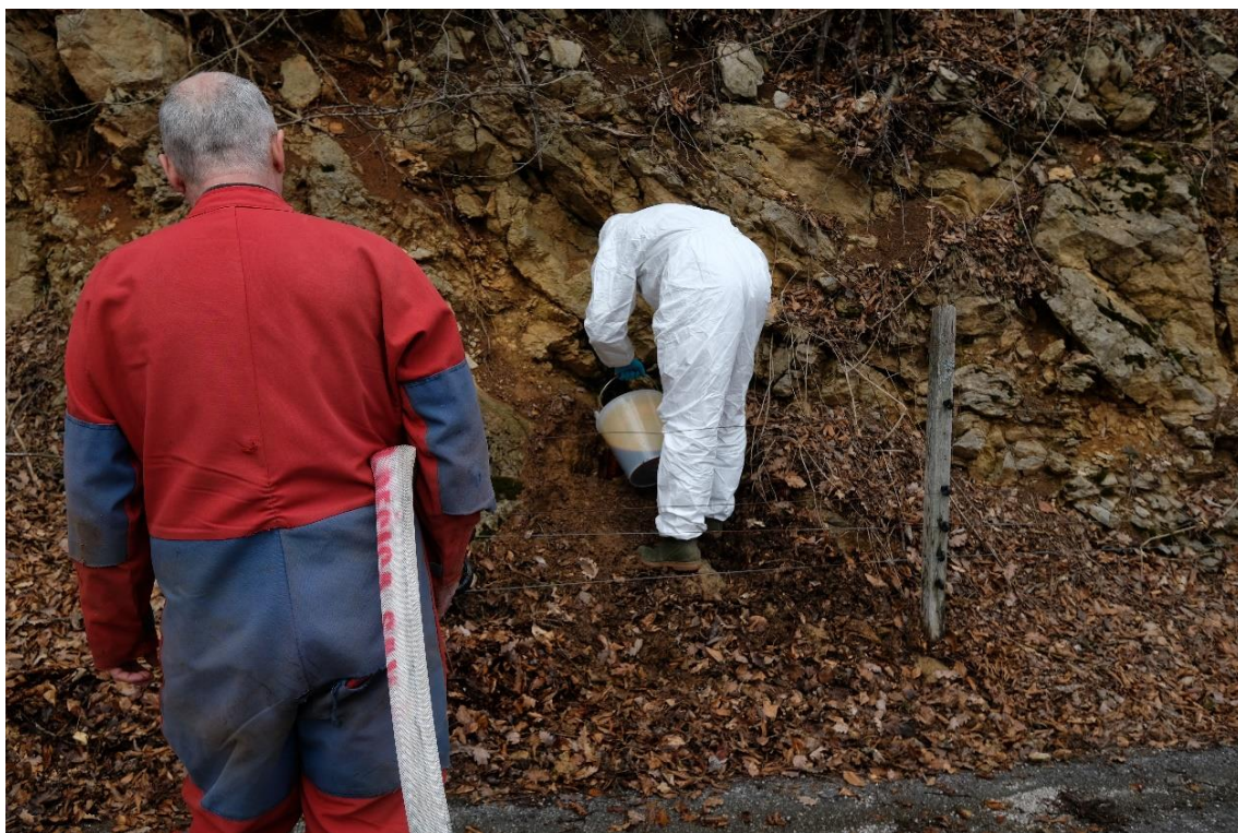
Slika 15: Injiciranje fluorescentnega sledila uranin v razpoko ob cesti proti kmetiji Bursečnik.
