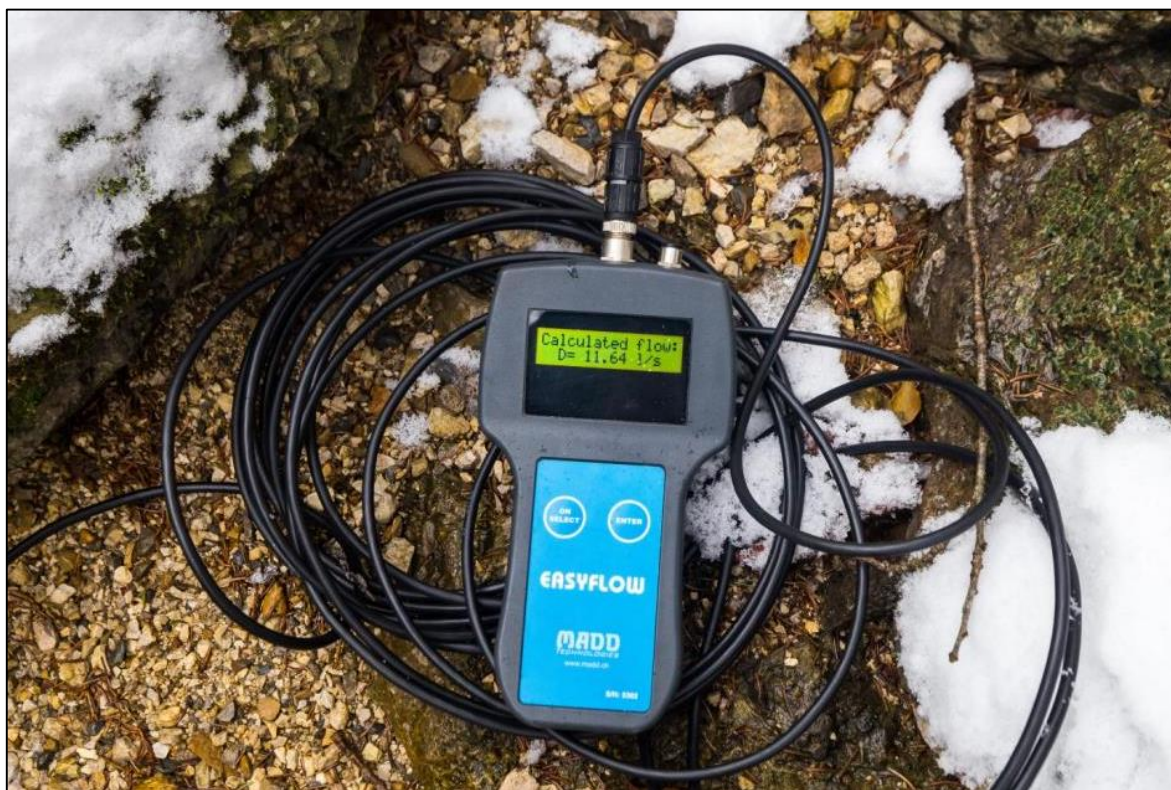
Slika 13: Merjenje slanosti in samodejno računanje pretoka z ročnim merilnikom MADD Easyflow.
