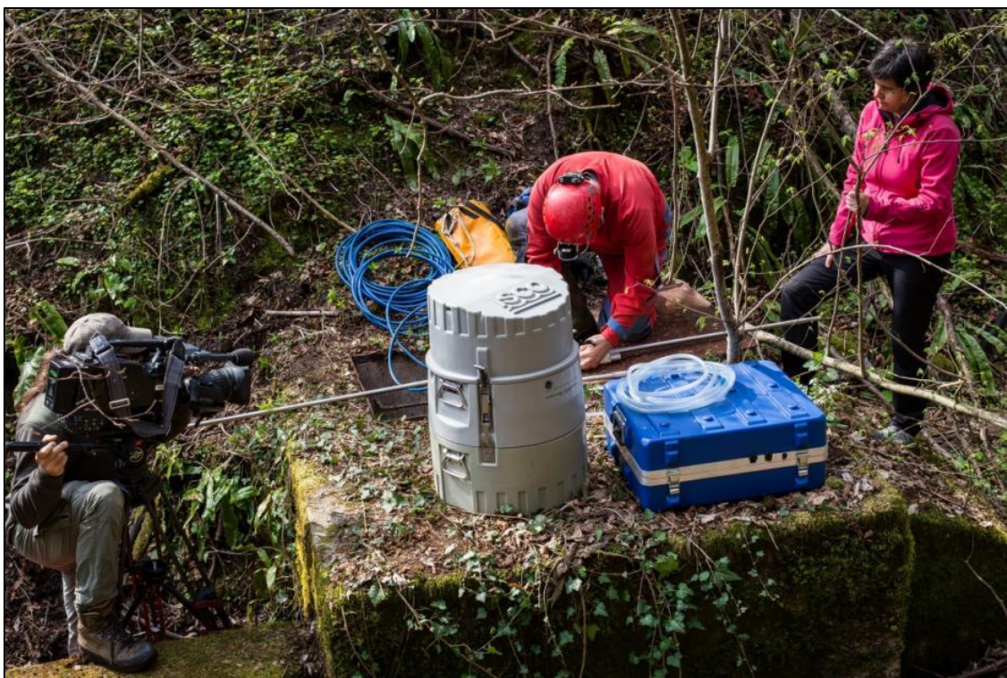
Slika 16: Namestitev raziskovalne opreme za avtomatsko vzorčenje vode in merjenje fluorescence na Žegnanim studencu.
