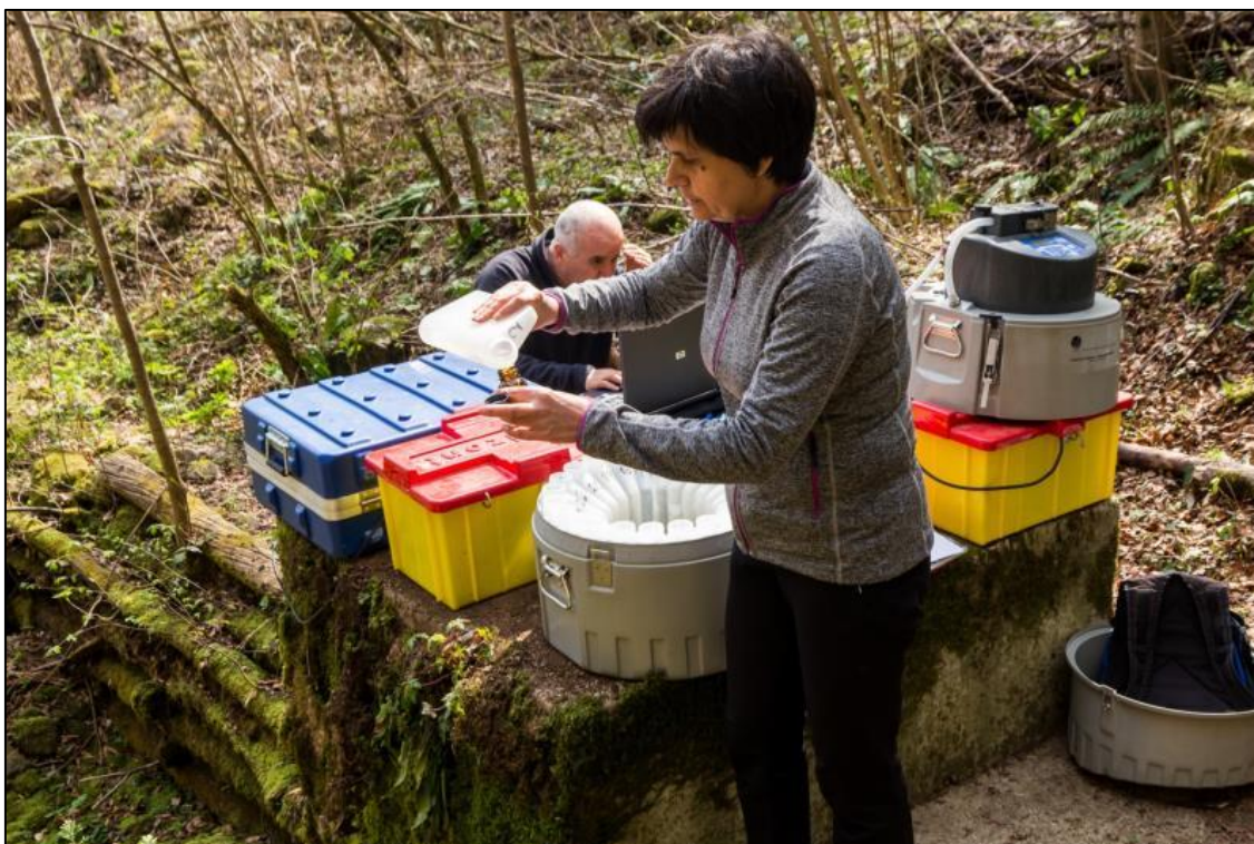
Slika 17: Pretakanje vzorcev vode iz avtomatskih vzorčevalnikov v stekleničke za analize v laboratoriju.
