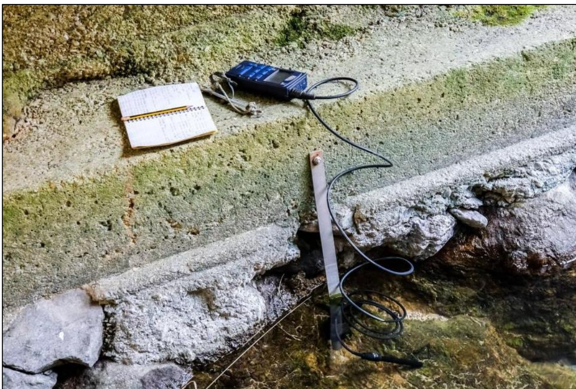
Slika 12: Merjenje specifične električne prevodnosti vode in temperature z merilnikom WTW Cond 330i (zgoraj) za umerjanje meritev s samodejnih merilnikov.
