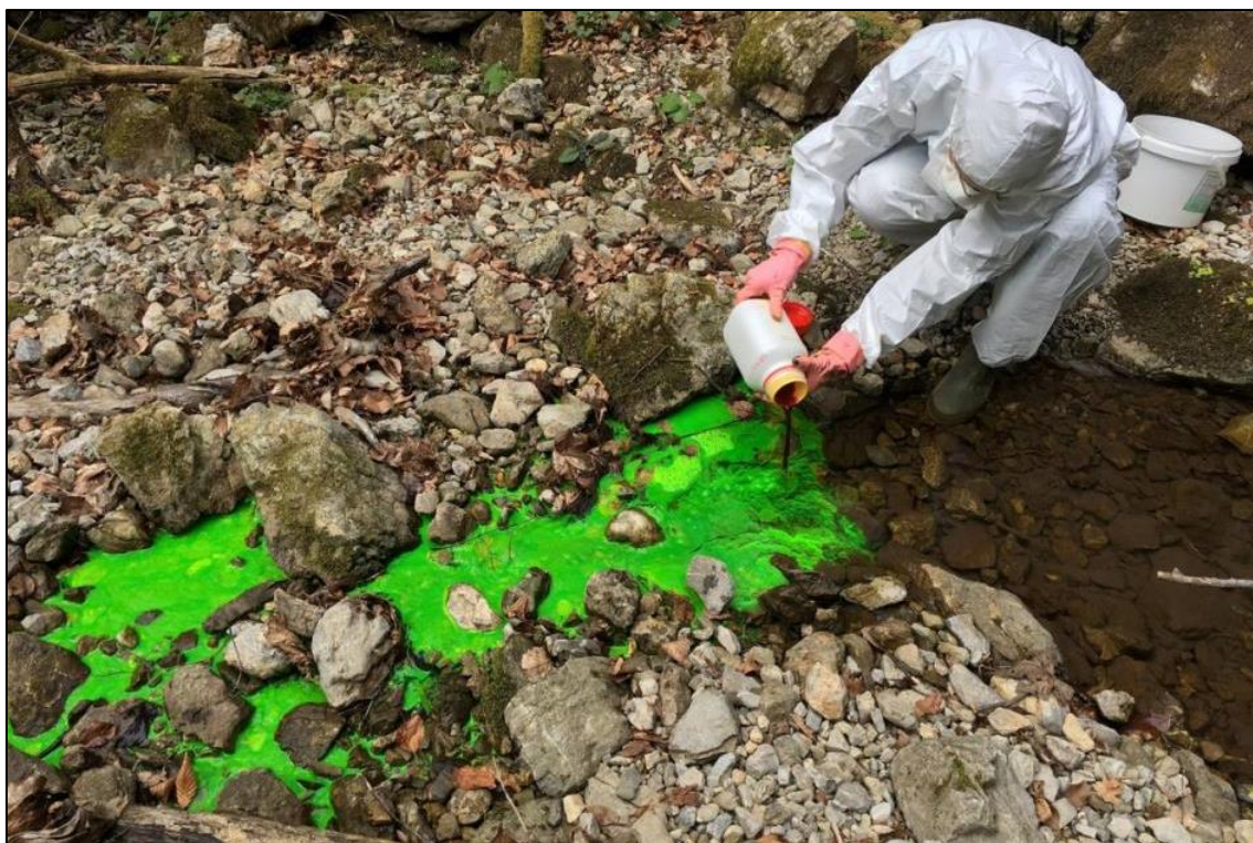
Slika 14: Injiciranje fluorescentnega sledila uranin v ponikajočo Suho.
